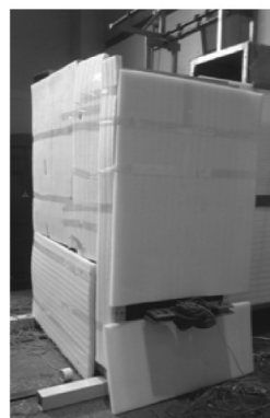
(b) 开关柜温升试验布置照片
